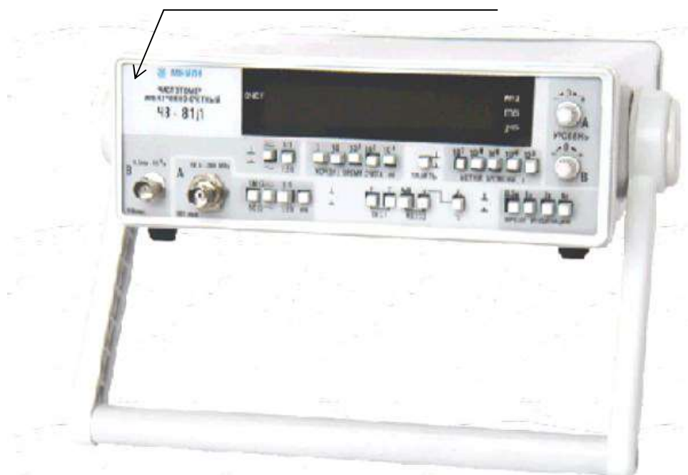
Рисунок 1 – Общий вид частотомера электронно-счетного ЧЗ-81 с указанием места нанесения знака поверки
